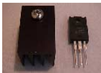
三端子レギュレーター（右） 放熱板（左） 写真8
